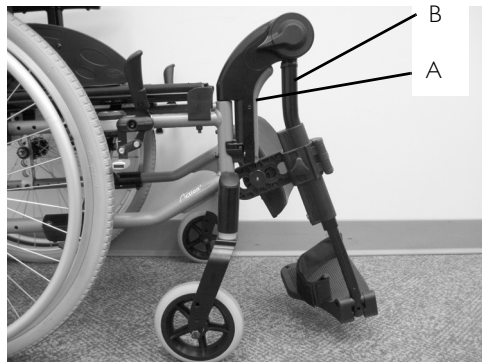
ILLUSTRATION 17 Installation et retrait des repose-jambes éleveurs - MyOn et MyOn Active - Retrait
