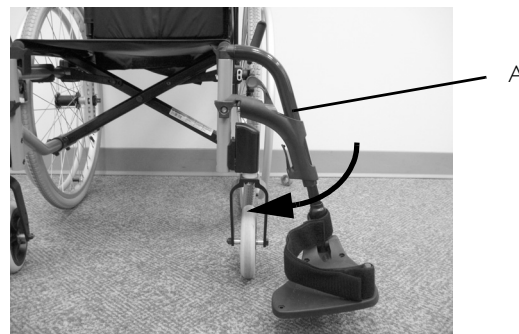
ILLUSTRATION 13 Installation et retrait des repose-pieds - MyOn et MyOn Active
