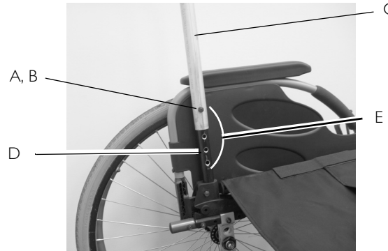
ILLUSTRATION 5 Réglage de la hauteur du dossier réglable
