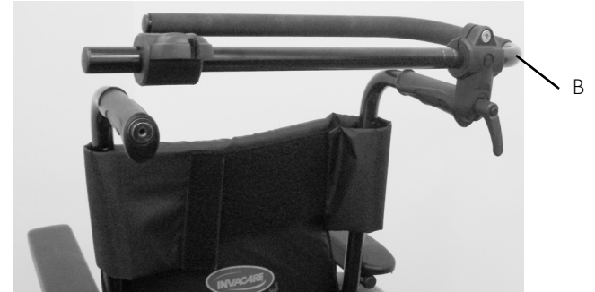
ILLUSTRATION 3 Fixation de la poignée de manœuvre optionnelle - MyOn Jr
